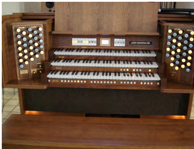
Registres de jeux à poussoirs et tirants, accouplements à bascule (dominos) – console cathédrale Papeete.
